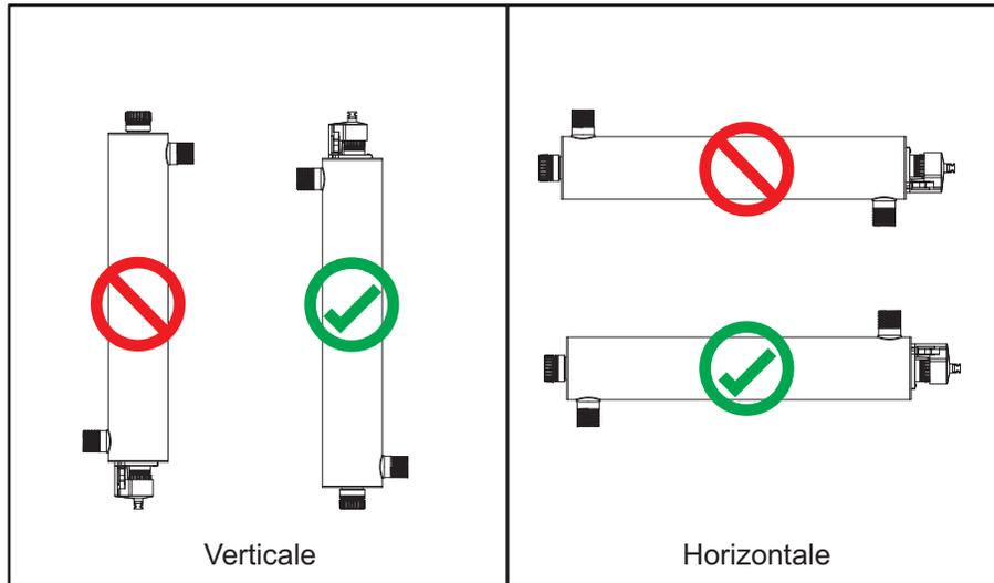
Figure 2 Installation du système de UV - Verticale et Horizontale
